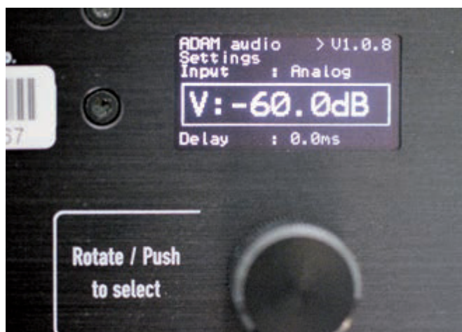
Abb. 5: Die rückseitige Lautstärkesteuerung verlangt etwas Eingewöhnung – die Anpassung der Parameter kann nicht für beide Boxen synchron erfolgen
